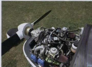
*Le Rotax 912 SFR, très correctement installé, ne comporte pas de réchauffage carburateur. Domage !*
